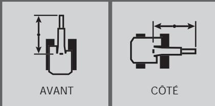
Les classements sont basés sur ISO 10567: 2007. La capacité de levage ne dépasse pas 75% de la charge de basculement avec la machine sur un sol ferme et de niveau ou 87% de la capacité de levage hydraulique.
